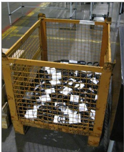
Figura 30. Esempio di stoccaggio materiale in un recipiente che, per collocazione a terra, forma e dimensioni, può indurre il lavoratore a ricorrere a movimenti ripetuti incongrui durante il prelievo dei particolari.
