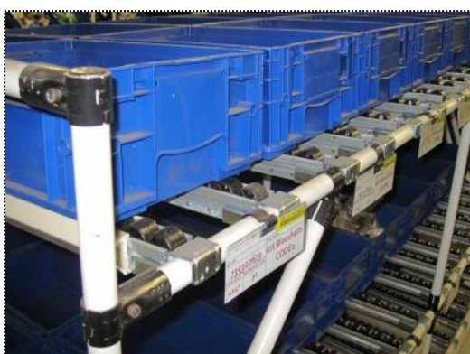
Figura 32. Serie di recipienti collocati in un contesto che rende difficile al lavoratore il controllo del contenuto ed il prelievo dei particolari.
