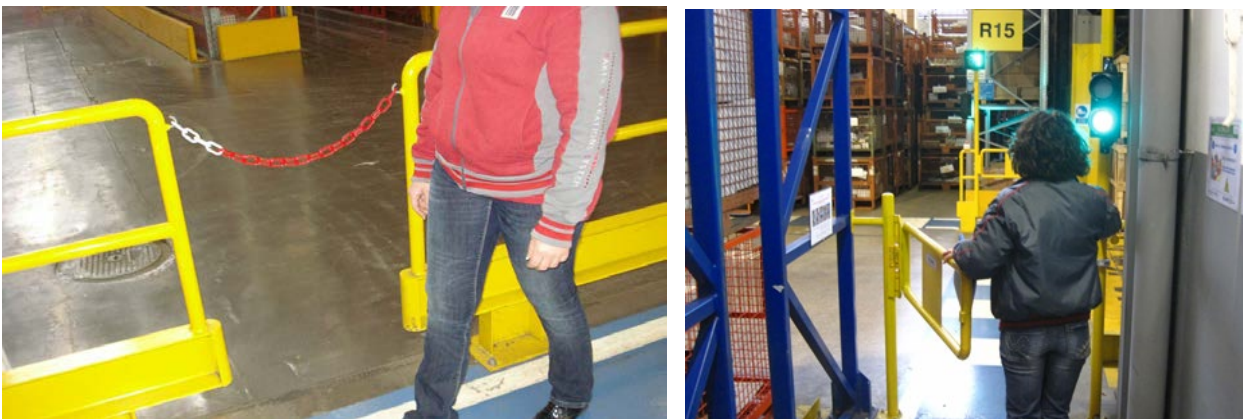
Figure 17 e 18. Esempi di separazione dei percorsi pedonali dalle vie di transito dei carrelli elevatori
