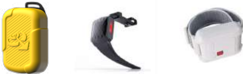
Figure 25, 26, 27. Esempi di “tag” indossabili per essere riconosciuti come “ostacoli” dal sistema anticollisione
