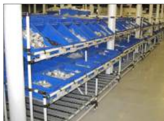
Figura 33. Ricollocazione dei recipienti in una posizione che favorisce un più agevole prelievo dei particolari da parte del lavoratore.
