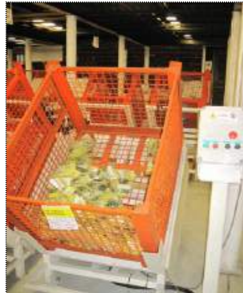
Figura 31. Recipiente collocato in una posizione rialzata e inclinata che favorisce un più agevole prelievo dei particolari da parte del lavoratore.
