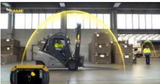
Figura 28. Il pedone munito di “tag” si avvicina all’area di allarme che circonda il veicolo: il monitor a bordo del veicolo allerta il conducente evidenziando in giallo l’area di provenienza del potenziale pericolo.
